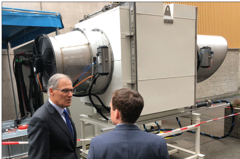
Eine DAC-Anlage von Climeworks in der Schweiz (Jay Inslee/Flickr)
