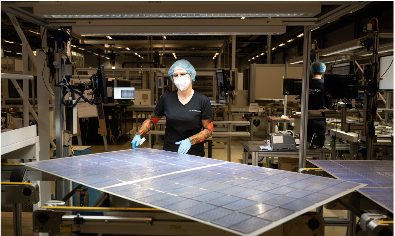
Freiberg: Qualitätskontrolle an einer Produktionslinie für Solarmodule im Werk der Meyer Burger Technology AG Foto: picture alliance/dpa/dpa-Zentralbild/Sebastian Kahnert
